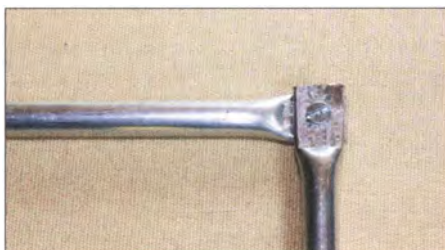
Bild 13: So können Verbindungen für 8-mm-Aluminiumrohre aussehen.
