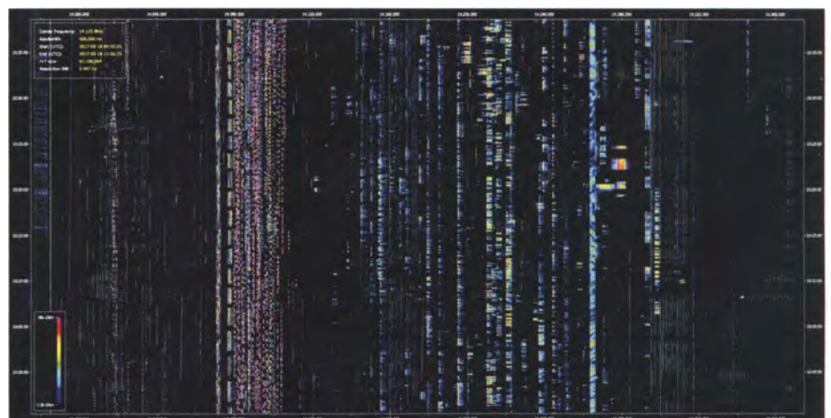
Bild 8: Aus einem bis zu 30 MHz breiten Bereich lassen sich frequenz- und zeitmäßig beliebige Bereiche herauszoomen – wie hier das 20-m-Amateurfunkband an einem Wochenende über eine Stunde. Deutlich zeichnen sich die unterschiedlichen Modulations- und Sendertypen ab, zudem belebt ein Contest den Datenfunkbereich um 14090 kHz.
