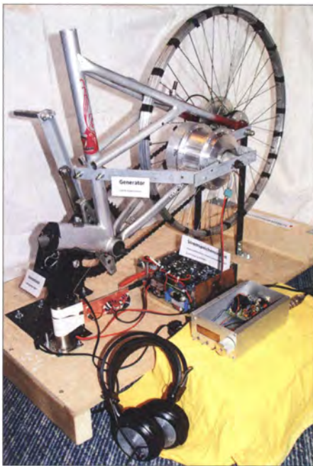
Bild 1: Aufbau der Selbstversorgertaste; vorn rechts befinden sich Gleichrichter und Speichereinheit mit Spannungswandler, rechts daneben der QRP-Transceiver mit Kopfhörer. Darüber hängt der als Generator genutzte 250-W-Nabenmotor. Der Pedalarm links fungiert als Morsetaste und gleichzeitig als Antrieb für den Generator.
