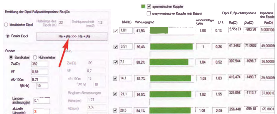
Bild 5: Ansicht nach erfolgter Transformation der Eingangsimpedanzen des hier 3 m langen Feeders (siehe Tabelle) in die Fußpunktimpedanzen des Dipols
