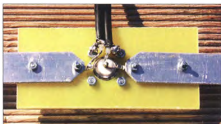
Bild 12: Mittelstück aus Flachmaterial mit den Koaxialkabeln des Halbwellenbaluns
