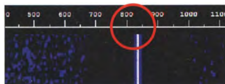
Bild 1: Das Sendesignal erscheint in 830 Hz Abstand vom Träger.
