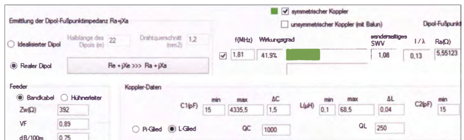
Bild 6: Der Beispieldipol hat auf dem 160-m-Band einen Wirkungsgrad von 42 %. Die Kopplerdaten beziehen sich auf den symmetrischen Koppler BX-1200 nach DL1SNG.
