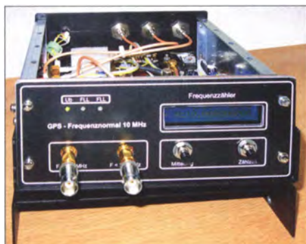
10-MHz-Frequenznormal auf GPS-Basis von Wolfgang Lässig, DL2JWL
