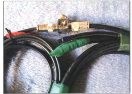
Bild 10: Die offenen Stub-Enden sind mit Schrumpfschlauch zu isolieren. Montierte Koaxialstecker erlauben den flexiblen Einsatz, auch als Einzelfilter.
