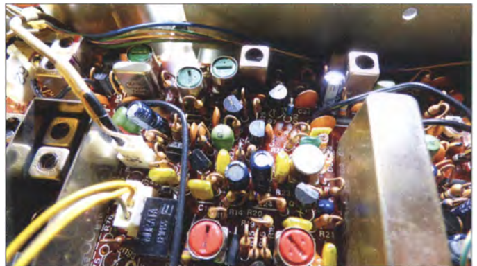
Bild 3: Die infolge Alterung verstimmt Filter mit den schwarzen und grünen Kernen auf dieser Platine waren die Ursache für zu geringe Empfängerempfindlichkeit und fehlende Sendeleistung beim TS-780.
