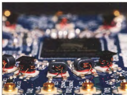
Bild 3: Jeder Antennenanschluss ist mit einem passenden Miniübertrager ausgestattet.
