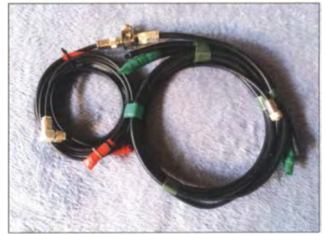
Bild 9: Fertiger 6-m-/4-m-Diplexer aus Koaxialkabeln, hier aus Aircell7 im 6-m-Zweig und Aircom+ im 4-m-Zweig (siehe Bild 7)
