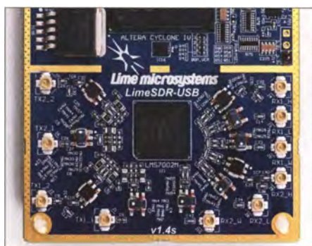
Bild 2: Blick auf das Antennenfeld mit seinen zehn U.FL-Buchsen zum Anschluss von Empfangs- und Sendeanennen für verschiedene Frequenzbereiche.
